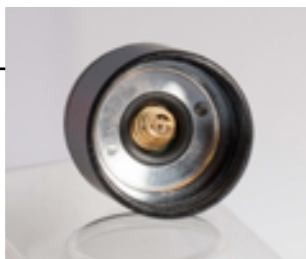
Die Feder (für Minuspol) im Innern des Batteriedeckels
