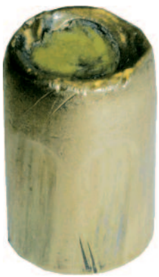
▲ Geschoss nach Auftreffen auf Hartmaterial: Keine wesentliche Deformation (axiale Stauchung). Durchschlägt vier Stahlbleche à 1 mm.
