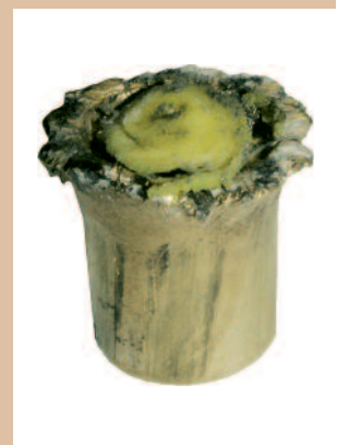
▲ Schuss durch Glas. Projektil verliert bis 10 % Gewicht.
